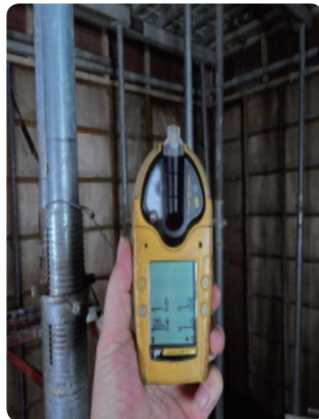
[사진2] 옥탑2층 기계실 내부(좌) / 기계실 내부 공기농도 측정(CO 20ppm, 산소 20.9%) (우)
