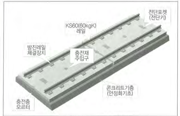
〈그림 4〉 "B"형 프리캐스트 슬래브궤도
